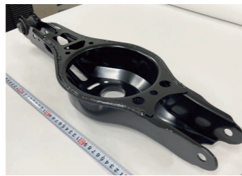
当社の鋼材で製作された「サスペンションロアアーム」
