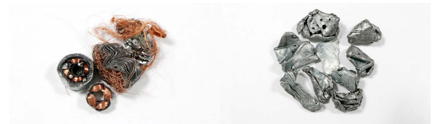
キャノンエコロジーインダストリーが回収した複合機から取り出した鉄（左：銅が付いた状態の鉄、右：純度99%に分別した鉄）
