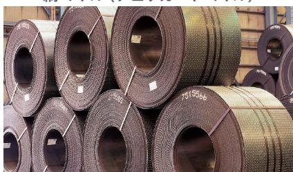
東京製鐵の縞コイルは、45°の縞目を持ち、滑り止め効果に優れています。各種建築物の床面、階段等様々な分野に使用されます。
