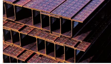
東京製鐵の縞H形鋼(チェックカードビーム)は、フランジ上面に滑り止め効果を発揮する格子模様を施すことにより、主に路面覆工板として地下鉄工事等に採用されています。
