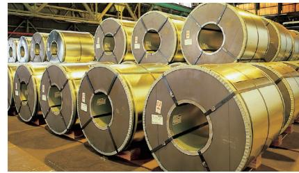
東京製鐵の溶融亜鉛めっきコイルは、優れた亜鉛密着性と美しく均一な表面性を実現しています。良質な加工性と優れた耐食性が高く評価されています。
