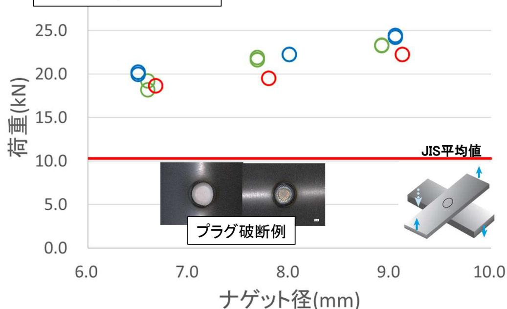
TSS: JISの平均値(15.4kN)<sup>※1</sup>を満し、各ナゲット径における破断形態に3鋼種間の差なし
