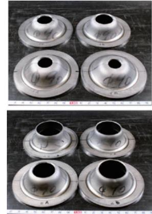
Photo2 穴拡げ試験後の試験片 (写真は、円筒の例)
