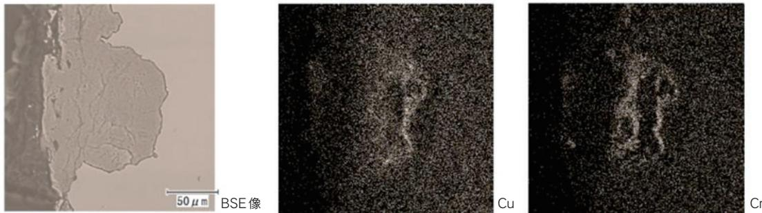
電気炉鋼材安定さび中のCuとCr
